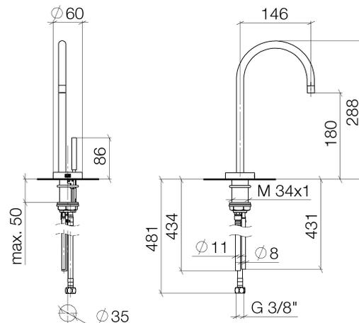
**Für die einwandfreie Funktion des HOT & COLD WATER DISPENSERs in Verbindung mit Heißwassertank und Filter ist ein Mindestfließdruck von 3 bar notwendig. Alle 6 Monate ist ein Wechsel der Filterkartusche erforderlich. Bitte beachten Sie die weiteren Hinweise in der Montageanleitung. Alle Professional Informationen und detaillierte Planungshinweise finden Sie auf [www.dornbracht.com](http://www.dornbracht.com)**
